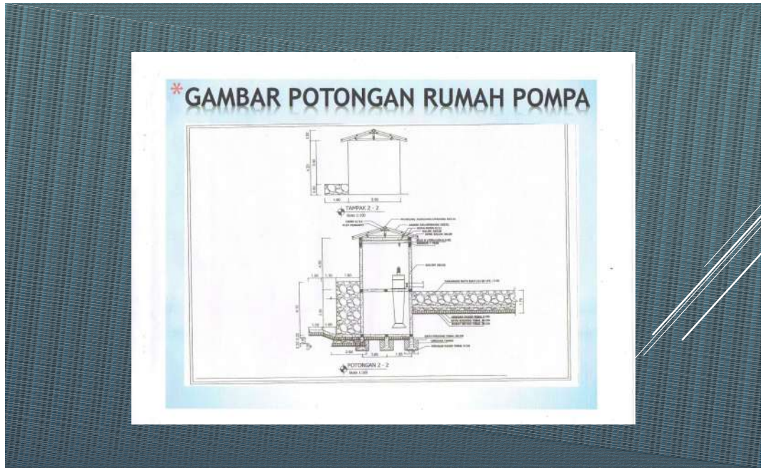
Gambar 13. Potongan Rumah Pompa
