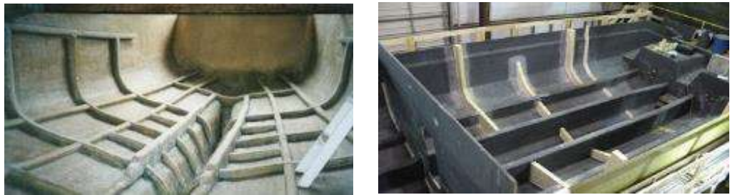
Gambar 14. Konstruksi Lambung Speedboat
