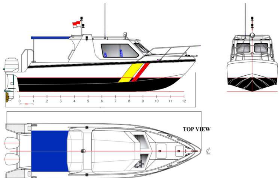
Gambar 26. Contoh Spesifikasi Dimensi Eksterior Speedboat
