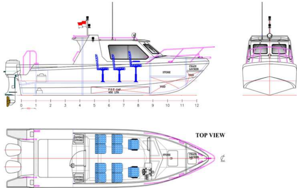
Gambar 27. Contoh Spesifikasi Dimensi Interior Speedboat
